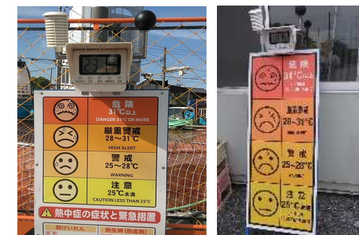
暑さ指数(WBGT)に応じて、 マスクを外しての作業を許可 (例:暑さ指数(WBGT)が21°C以上の場合は外してもよい)
