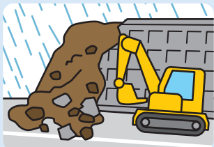
道路工事中、ゲリラ豪雨のため、完成直前の盛土法面が崩壊した
